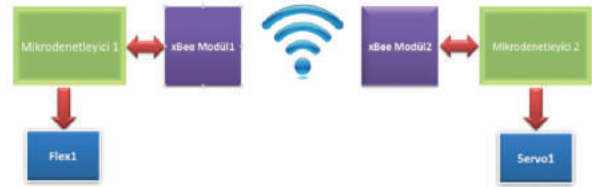
Şekil 2. Teksensör için devre genel blok diyagramı
