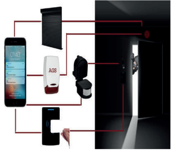
Şekil 2: Kurulumu yapılmış sistemin çalışma şeması.
