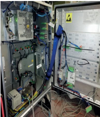
Şekil 2: Kontrolcü(IRC5) ile I/O Bağlantısı
