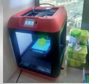
Şekil 2: Robot dış gövdesinin 3-D yazıcıda üretilmesi
