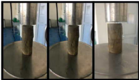
Şekil 1: Serbest basınç deney numunesi ve göçme düzlemi
